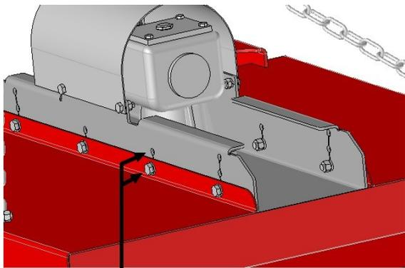
Réglage de la hauteur de coupe avec 2 positions par déplacement du bloc support renvoi d'angle
